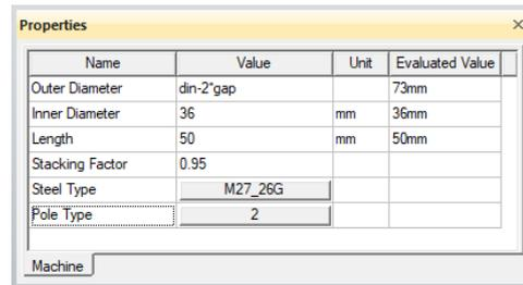
Figure 16. ANSYS RMxprt: rotor core parameters
