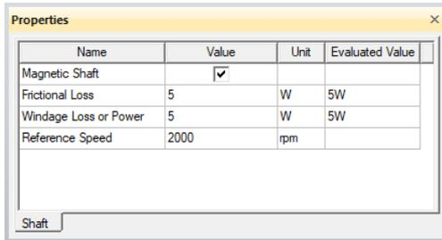
Figure 20. ANSYS RMxprt: shaft parameters
