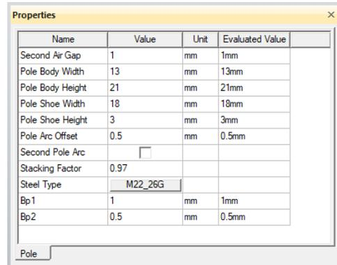
Figure 11. ANSYS RMxprt: inductor pole parameters
